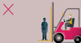
impedire il passaggio al di sotto delle forche di carico alzate
